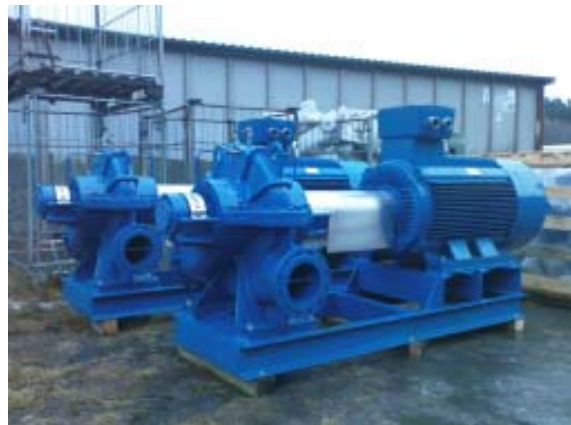
Horisontaldelade ( split case) SDS 350/400 2400 m 3 /h - 35 m
