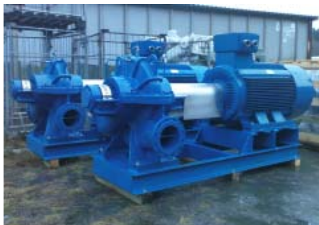
Vattenpump Q = 630 \text{ m}^3/\text{h} H = 90 \text{ m}
