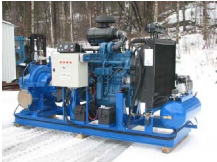
Dieseldriven Brandvattenpump Q = 630 \text{ m}^3/\text{h} H = 120 \text{ m}
