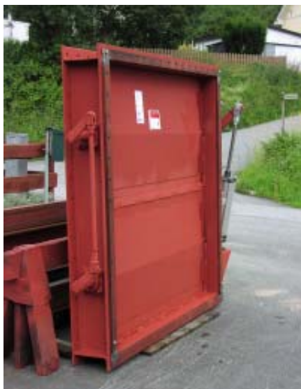
2-bladigt avstängningsspjäll DN 1500 x 2200 mm
