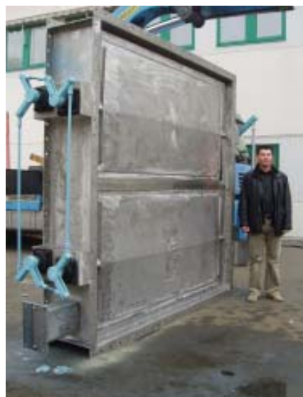
Dubbelspjäll med uttag för spärrluft 2500 x 2500 mm
