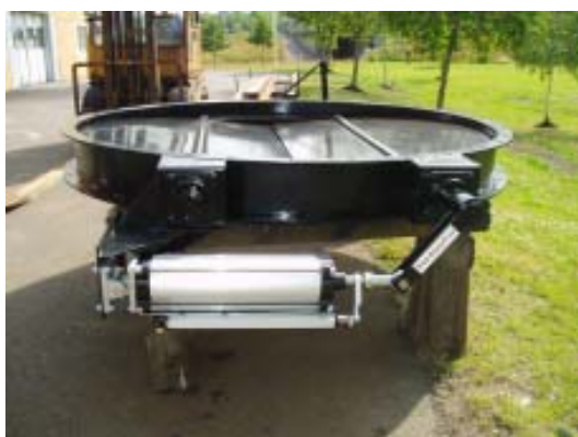
2-axlat DN 2500 mm material: stål
