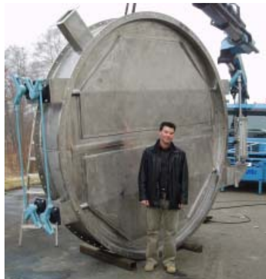
Dubbelspjäll med uttag för spärrluft DN 3200 mm
