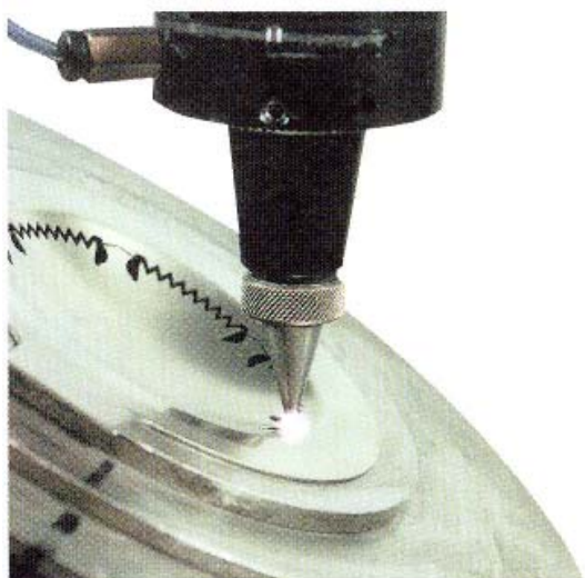
Bleck under lasertillverkning. Tillverknings tolerans försumbar
