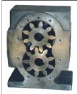
Principen för en s.k. ytterkugghjulspump
