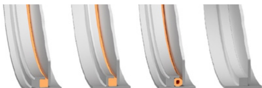
Exempel på tätningar från vänster: Bild 1 & 2: Glasfibertätning. Bild 3: Silikonslang. Bild 4: Ståltätning.
